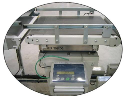
*Intégration de modules de pesée sous nos convoyeurs*
